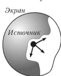
Рис.2. Приспособление, позволяющее увидеть, по каким направлениям вылетают частицы из точечного источника
